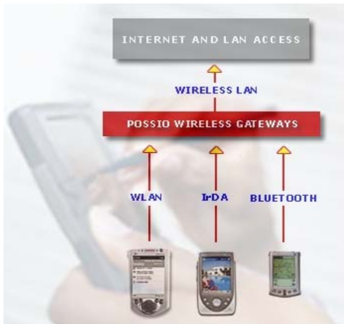
Figur 9. Access point för flera typer av trådlösa nätverk. Källa: Possio
